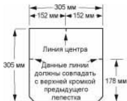
Рис. 9. Монтаж коньковой черепицы RUFLEX Esten
