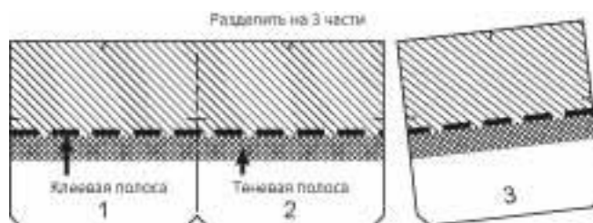
Рис. 1. Трехтабовый гонт гибкой черепицы RUFLEX Esten
